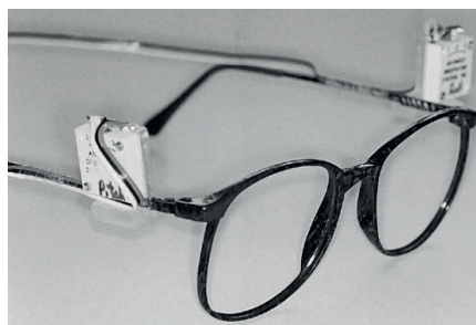
Рис. 2. Датчики инклинометра на оправе очков без стекол [Uşümez, 2001]
