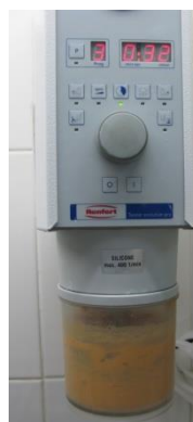
Рис. 5. Замешивание гипса в автоматическом вакуумном миксере.
