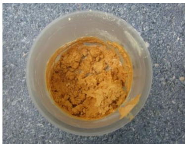
Рис. 4. Гипс замешан по рекомендованной производителем пропорции вручную.
