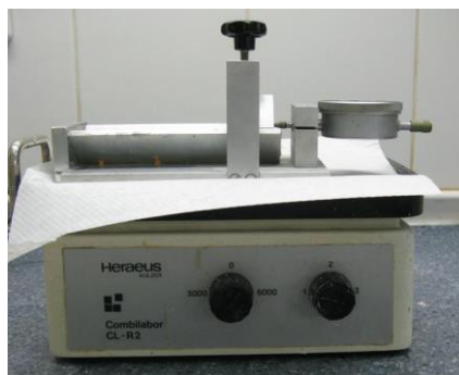
Рис. 8. Прибор установлен на вибростол.
