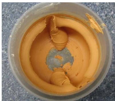
Рис. 6. Вид гипса после замешивания в вакуумном миксере.
