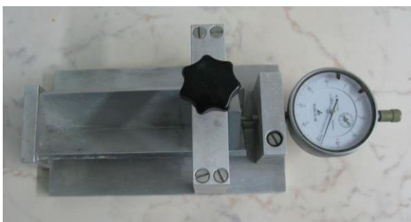
Рис. 7. Прибор для измерения расширения гипса.
